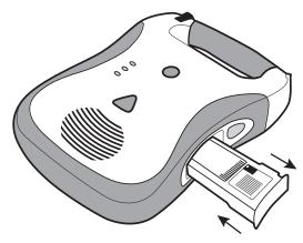
l'ouverture de la batterie sur le côté du DAE est propre et dégagée de tout objet étranger. Insérer la batterie dans l'ouverture sur le côté du DAE. Glisser l'ensemble batterie jusqu'à ce que le verrou clique. Si l'ensemble batterie ne s'enfonce pas, elle est probablement à l'envers. Une fois insérée, la surface de la batterie doit être à niveau égal du DAE.
