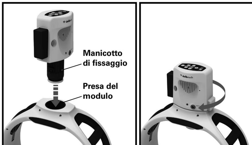
Per rimuovere il modulo di compressione dal telaio, fare pressione sul modulo di compressione, quindi ruotarlo di circa 90° in una delle due direzioni. A questo punto il modulo di compressione può essere estratto dal telaio. Prestare attenzione a non far cadere il modulo.
