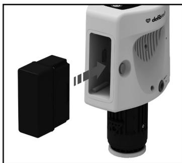
Prima di inserire il gruppo batteria all'interno del dispositivo ACC RMU-1000, assicurarsi che l'apertura del gruppo batteria situata sul lato del modulo di compressione sia pulita e priva di corpi estranei. Inserire il gruppo batteria all'interno dell'apertura sul lato del modulo di compressione ACC. Spingere il gruppo batteria sino in fondo fino a udire il clic dell'elemento di bloccaggio. Il gruppo batteria funziona in entrambi gli orientamenti (con i contatti rivolti verso l'unità).
