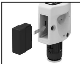
在將電池組安裝至 RMU-1000 自動胸部按壓機上以前，確定按壓模組側邊的電池組開口乾淨並沒有任何異物。將電池組插入自動胸部按壓機按壓模組側邊的開口。將電池組推到底，直到門鎖鎖上。電池組朝任一方都可以提供電源（在接觸點朝向設備的情況下）。
